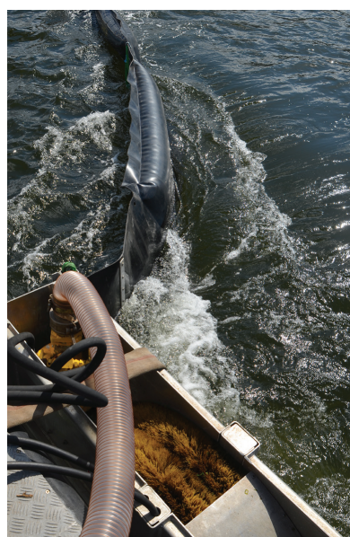
Skimmeris jeb naftas produktu savākšanas ierīce, kas atgādina rotējošu birsti.
